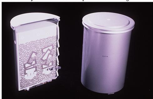
Maquette des colis de coques et embouts cimentés
