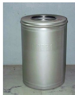
Fût en acier inoxydable d'enrobés bitumineux
