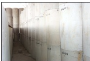
Coques en béton de 500 litres pour entreposage
