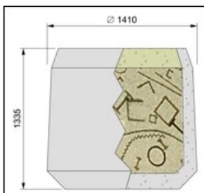
Schéma d'une coque béton 1 800 litres (en mm)
