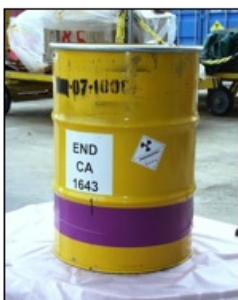
Fût métallique de boues et concentrats cimentés
