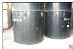
Colis de blocs sources reconditionnés en conteneurs en acier puis entreposés à Cadarache
