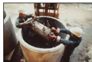
Sources déposées en conteneurs en béton avant injection
