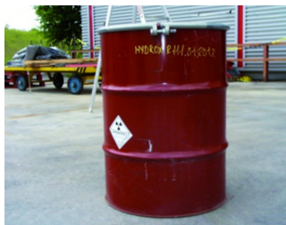
Fût métallique de déchets cimentés
