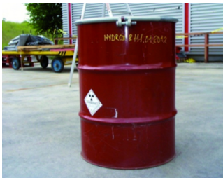
Fût métallique de déchets cimentés
