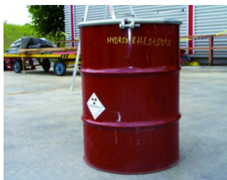
Fût métallique de déchets cimentés
