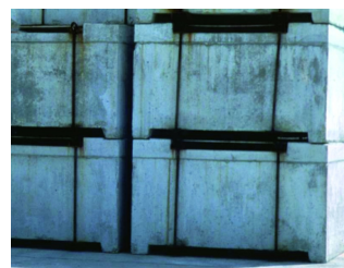
Cases graphite de Bugey en entreposage
