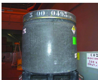
Coques béton de boues et concentrats cimentés
