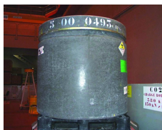
Coques béton de boues et concentrats cimentés
