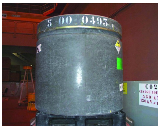
Coques béton de boues et concentrats cimentés
