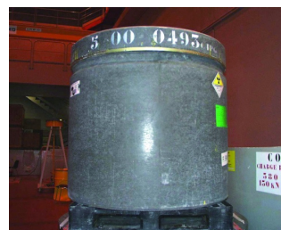
Coques béton de boues et concentrats cimentés
