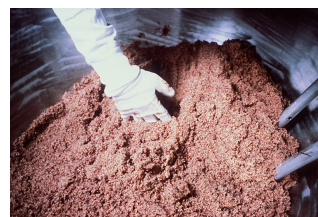
Résines échangeuses d'ions avant utilisation (non contaminées)
