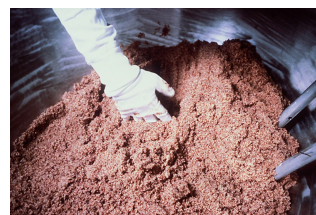
Résines échangeuses d'ions avant utilisation (non contaminées)
