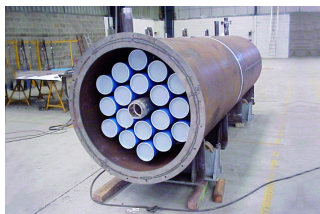
Colis contenant des protections neutroniques
