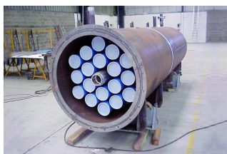
Colis contenant des protections neutroniques
