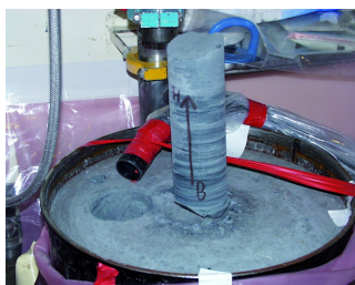
Extraction d'une carotte, d'un fût de cendres cimentées, pour expertise
