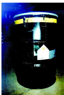
Fût métallique de déchets compactés et cimentés
