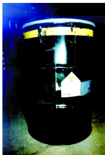
Fût métallique de déchets compactés et cimentés
