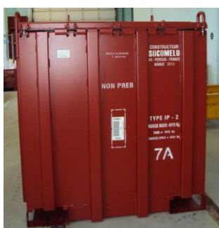
Caisson métallique de 5 m 3
