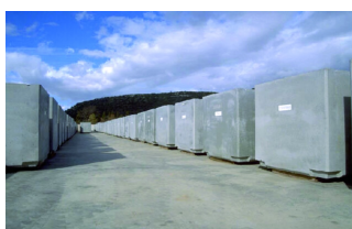
Conteneurs béton-fibres cubiques à Marcoule
