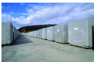
Conteneurs béton-fibres cubiques à Marcoule
