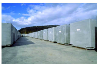
Conteneurs béton-fibres cubiques à Marcoule
