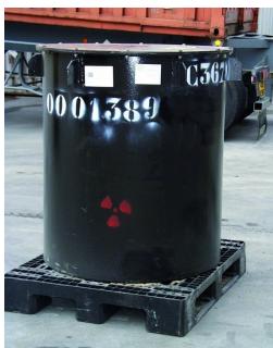
Fût métallique de concentrats cimentés
