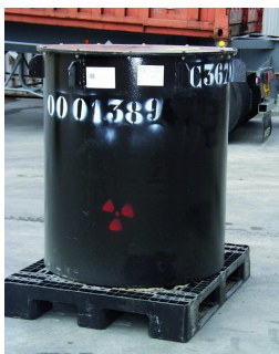
Fût métallique de concentrats cimentés
