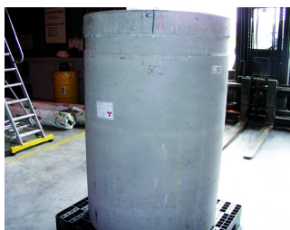
Coques béton-fibres de déchets d'exploitation ou de démantèlement
