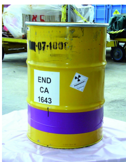
Fût métallique de boues et concentrats cimentés
