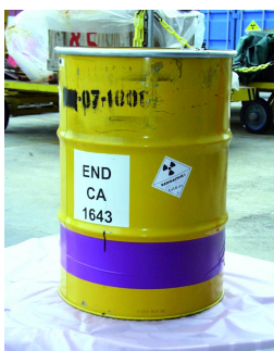
Fût métallique de boues et concentrats cimentés
