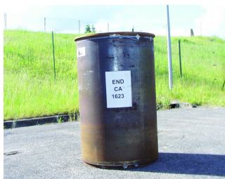
Fût métallique de résidus d'incinération cimentés
