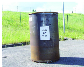
Fût métallique de résidus d'incinération cimentés
