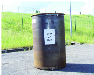
Fût métallique de résidus d'incinération cimentés
