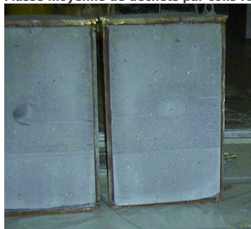
Coupe d'un fût de résidus d'incinération cimentés, pour expertises
