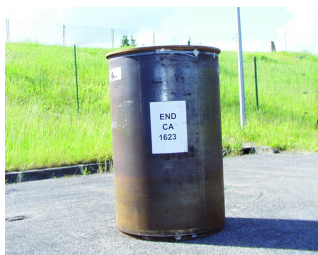
Fût métallique de résidus d'incinération cimentés
