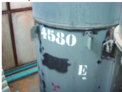
Fût de paratonnerres au radium (870 litres)
