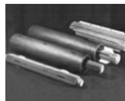
Chemises en graphite - Fil de selle en acier inoxydable - Magnésium - Uranium au cœur du Mg
