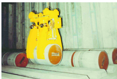
Alvéole d'entreposage des CAC
