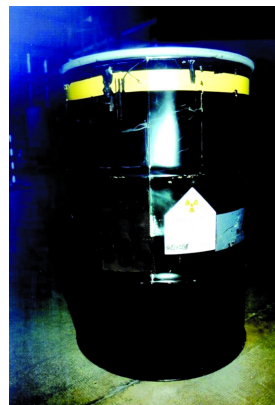
Fût métallique de déchets compactés et cimentés
