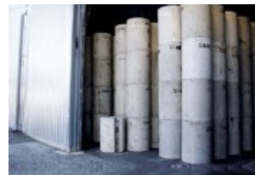
Coques béton contenant des fûts métalliques de boues et concentrats
