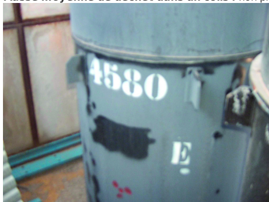
Fût de paratonnerres au radium (870 litres)
