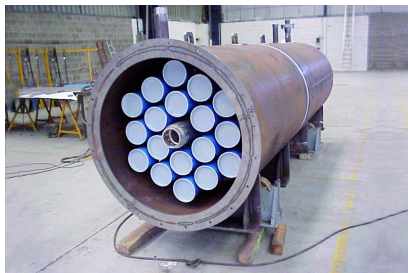
Colis contenant des protections neutroniques
