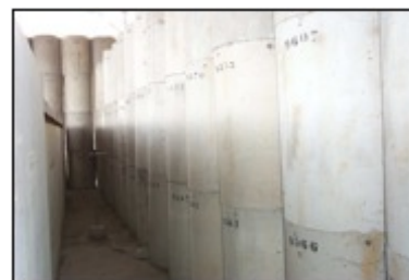
Coques en béton de 500 litres pour entreposage
