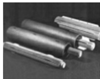
Chemises en graphite - Fil de selle en acier inoxydable - Magnésium - Uranium au cœur du Mg
