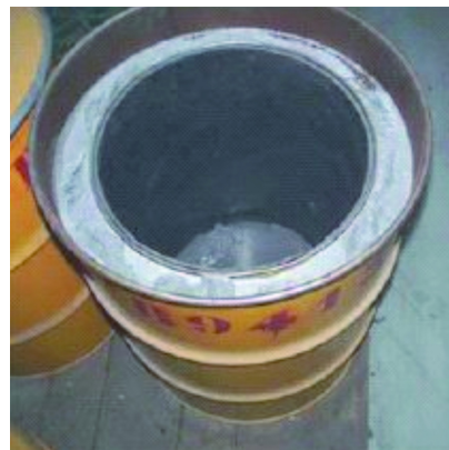
Colis pour sources radioactives scellées (fût métallique pré-bétonné)
