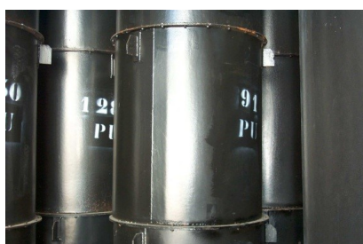
Conteneurs métalliques de déchets solides
