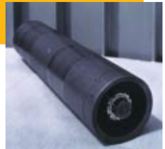
Chemise graphite entourant le combustible "uranium naturel graphite gaz"
